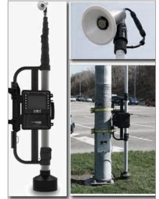
Aufgebaute Kamera für Verkehrserhebung (Quelle: IVV)
